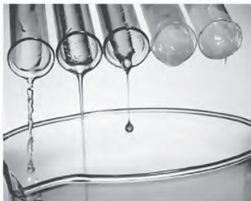
شکل ۱- مقایسه روانی جریان سیالات با لزجت متفاوت
