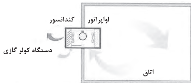
شکل ۱۲- سیستم کویل انبساط مستقیم (DX - Coil System)
