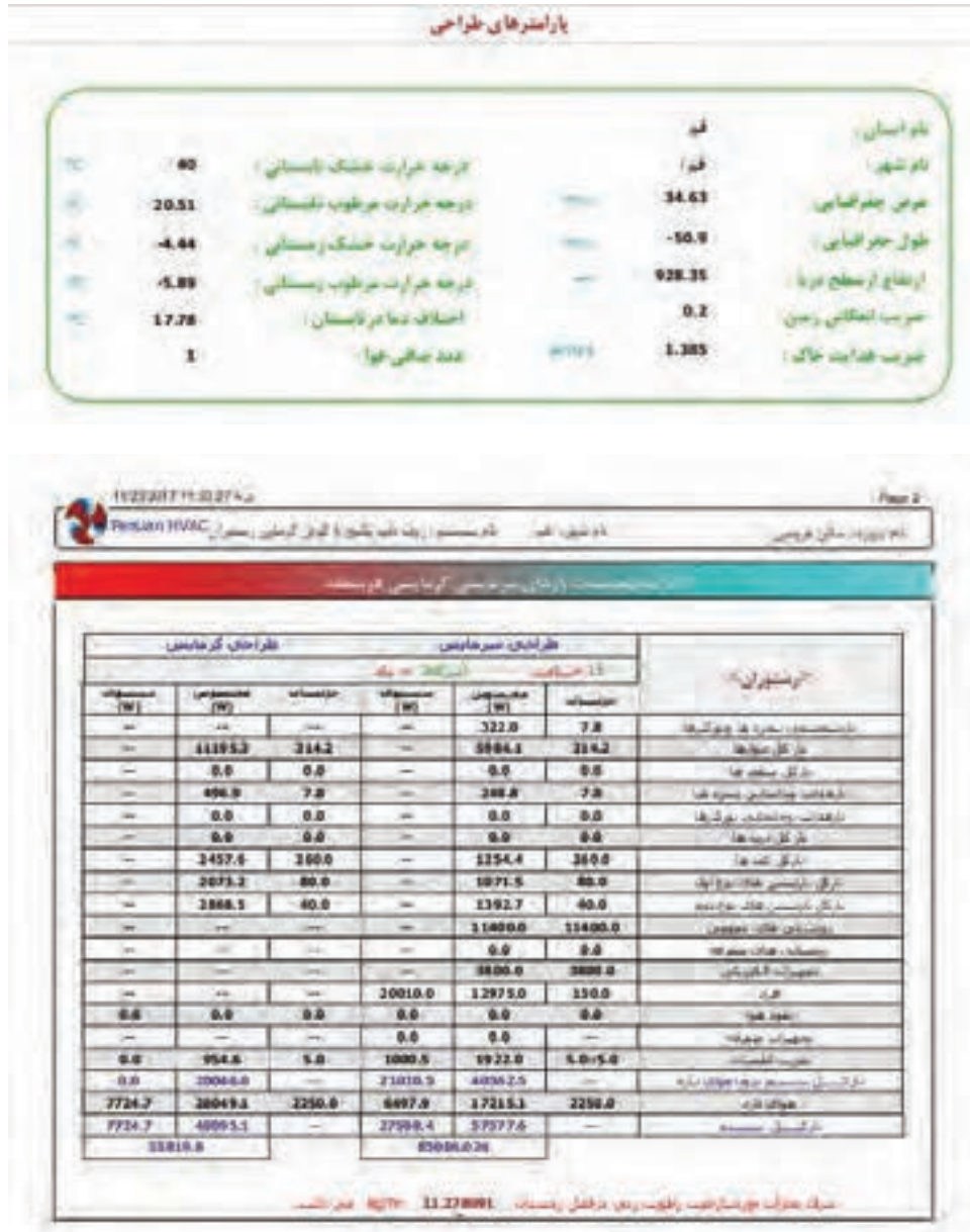
شکل ۳ - گزارش خلاصه بار فضاها Persian HVAC
